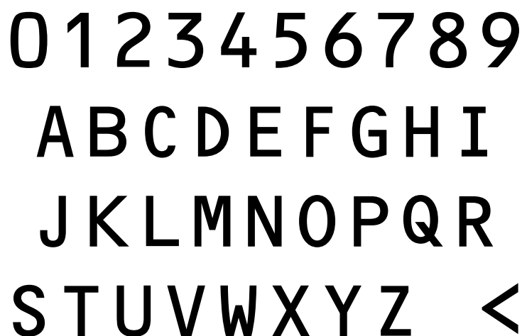
Рис. 4. Наборы знаков OCR-B из документа [ИСО 1073-2] для использования в машиносчитываемых проездных документах
